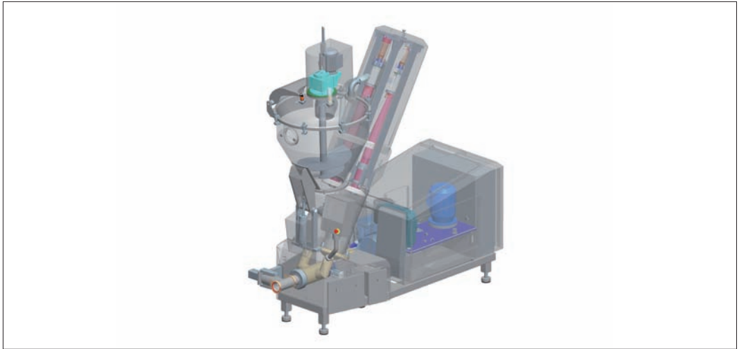
▲ Foto 7: Diseño 3D embutidora automática de músculo entero: TWINVAC PLUS.
